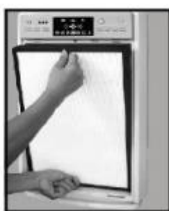
Vyjmutí filtru HEPA
